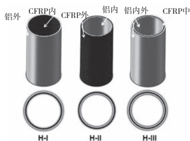
图 7 不同混合形式的铝/CFRP 混合圆管 [24]
